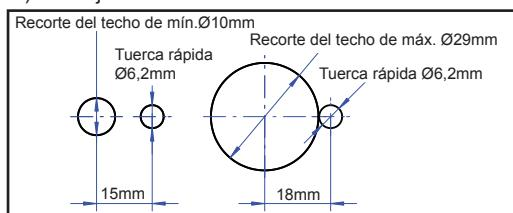
Según el recorte del techo perfore en una distancia (medio del agujero del recorte del techo - medio del agujero del recorte de la tuerca rápida) de al menos 15mm y al máximo 18mm al lado del recorte del techo un agujero para la tuerca rápida. Incluidas en el volumen de entrega están una tuerca rápida para techos de chapa y una tuerca para atornillar para techos de madera. Meta respectivamente atornille la tuerca en el agujero, conecte la lámpara y atornille la lámpara bajo el techo.
