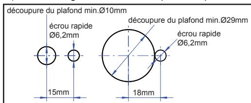
Selon la découpe du plafond vous forcez dans une distance (milieu du trou de la découpe du plafond – milieu du trou de l'éclou rapide) d'au moins 15mm ou max. 18mm à côté de la découpe du plafond un trou pour l'éclou rapide. Un éclou rapide pour des plafonds en tôle et un écrou à visser pour des plafonds en bois sont inclus dans le contenu de livraison.
