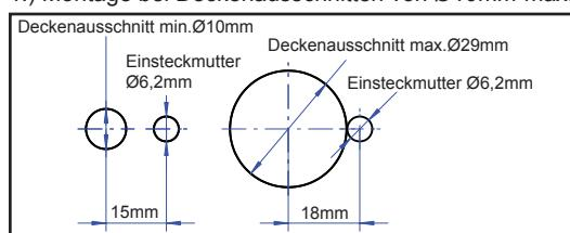
Je nach Deckenausschnitt bohren Sie in einem Abstand (Mitte Loch Deckenausschnitt - Mitte Loch Einstekmutter) von mindestens 15mm und max.18mm neben den Deckenausschnitt ein Loch für die Einstekmutter. Im Lieferumfang sind eine Einstekmutter für Blechdecken und eine Einschraubmutter für Holzdecken vorhanden.
