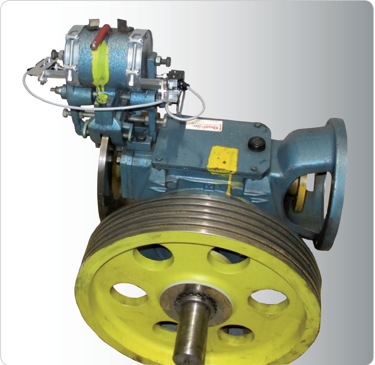
Anbaubeispiel Bremsüberwachung an einem alten Antrieb
