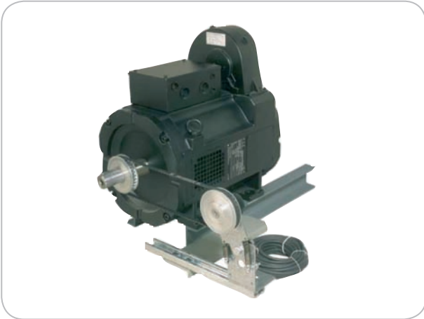
Montagebeispiel Anbausatz mit Zahnriemen und Federvorspannung
