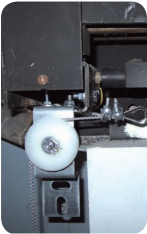
A Befestigung der Umlenkrolle auf Rollenwinkel
