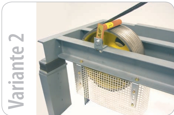
Anbaubeispiel der Fingerschutzvariante 2 , wenn die Umlenkrolle max. 100mm über dem Maschinenrahmen liegt.
