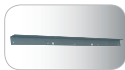
Blechwinkel, verzinkt, 28 x 28mm, t=1mm mit Löchern für die Blech- schraubenbefestigung, passend für vorstehende 8er Lochbleche
