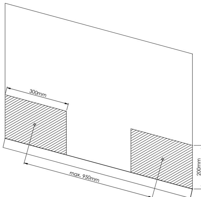
Pour remplir les exigences de la EN81-20 les contre-fiches de renforcement doivent être fixées dans la zone marquée de la tôle.
