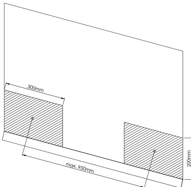
Um die EN81-20 zu erfüllen, müssen die Verstärkungsstreben in dem markierten Bereich an dem Blech befestigt werden.
