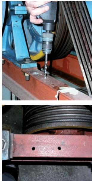
Die Löcher zunächst mit dem 3,5mm Bohrer vorbohren. Wenn möglich, mittlere Drehzahl der Bohrmaschine wählen.
