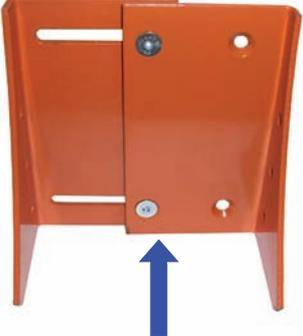
Ist die Treibscheiben- / Umlenkrollenbreite kleiner als 88mm, muss die vordere Schutzplatte (Teil 6a) mit einem Trennschleifer gekürzt werden.
