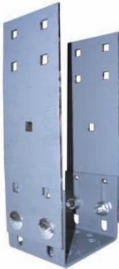
Zunächst werden die zwei Verlängerungsplatten (Teil 8) an den Winkel geschraubt. Hierfür werden die Flachrundschrauben M10x25 verwendet.
