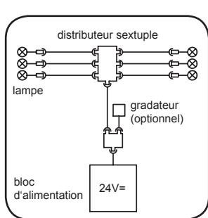
Veuillez prévoir à une position appropriée dans le plafond de la cabine un caniveau de câbles de 12mm pour la conduite entre le distributeur sextuple et le bloc d'alimentation vers le toit de la cabine. Utilisez pour cela le caniveau de caoutchouc ci-joint. Le bloc d'alimentation ne devrait pas être placé dans le plafond de la cabine.
