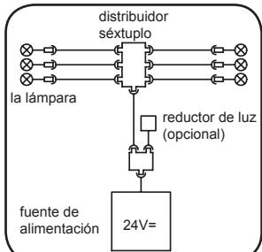
Prevea un canal para cables de 12mm en un punto apropiado en el techo de la cabina para la línea entre el distribuidor séxtuplo y la fuente de alimentación hacia el tejado de la cabina. Utilice el canal de cables de goma adjunto para esto. La fuente de alimentación no se debería ubicar en el techo de la cabina.
