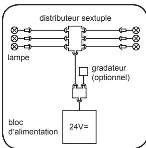
Veuillez prévoir à une position appropriée dans le plafond de la cabine un caniveau de câbles de 12mm pour la conduite entre le distributeur sextuple et le bloc d'alimentation vers le toit de la cabine. Utilisez pour cela le caniveau de caoutchouc ci-joint.
