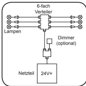
Sehen Sie an geeigneter Stelle in der Kabinendecke zum Kabinendach hin eine 12mm große Durchführung für die Leitung zwischen 6fach-Verteiler und Netzteil vor. Nutzen Sie hierfür die mitgelieferte Gummi-Kabeldurchführung. Das Netzteil sollte nicht in der Kabinendecke untergebracht werden.
