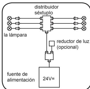
Prevea un canal para cables de 12mm en un punto apropiado en el techo de la cabina para la línea entre el distribuidor séxtuplo y la fuente de alimentación hacia el tejado de la cabina. Utilice el canal de cables de goma adjunto para esto. La fuente de alimentación no se debería ubicar en el techo de la cabina.
