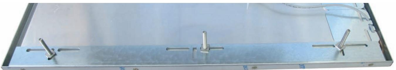
Si le panneau lumineux n'est pas monté directement sous le toit de la cabine, mais doit être suspendu un peu plus bas, il est recommandé de visser des écrous M8 sur les filetages. Sinon, on risque de pousser le plafond vers le haut ou d'endommager le parachute lors de son déclenchement. Les 6 écrous doivent avoir la même hauteur.
