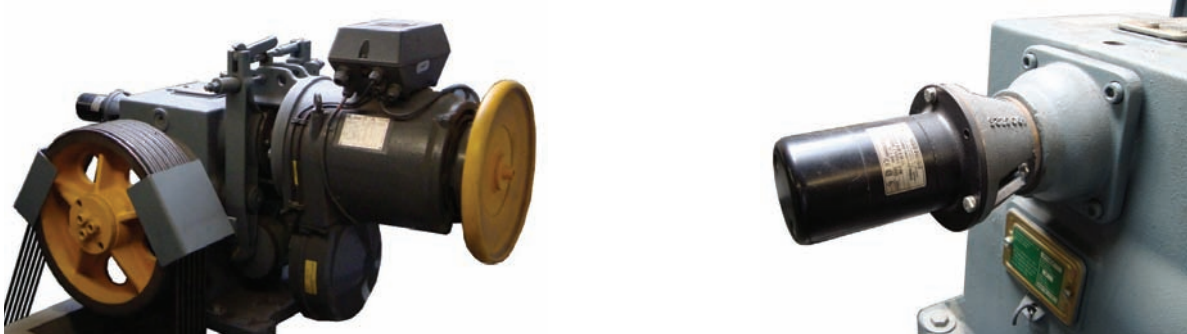
Motor mit Getriebe und altem Tachogenerator/ Motor with gear and speedometer generator
