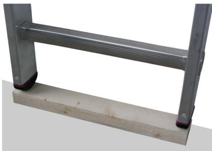
Coloque la escalera en la placa de madera entregada en la posición deseada. Entre el extremo de la escalera y el suelo hay que estar una distancia de 60mm.
