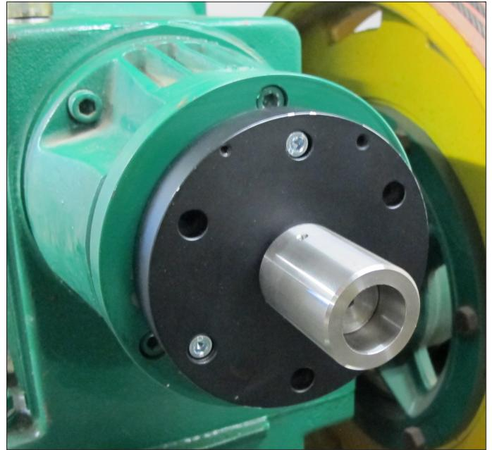
6. Gewindestift für Drehmomentstütze in Kupplungsstück schrauben und Hohlwellengeber montieren.
